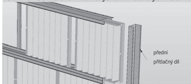
Obrázek 30 – uložení vložkových a rámečkových filtrů
